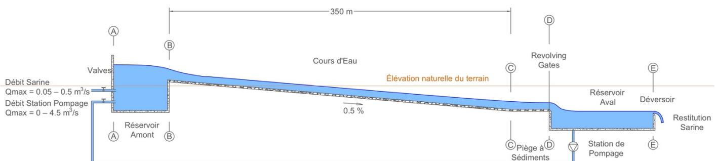
permanent et uniforme. L'équation de Manning-Strickler a permis de déterminer les hauteurs d'eau.
